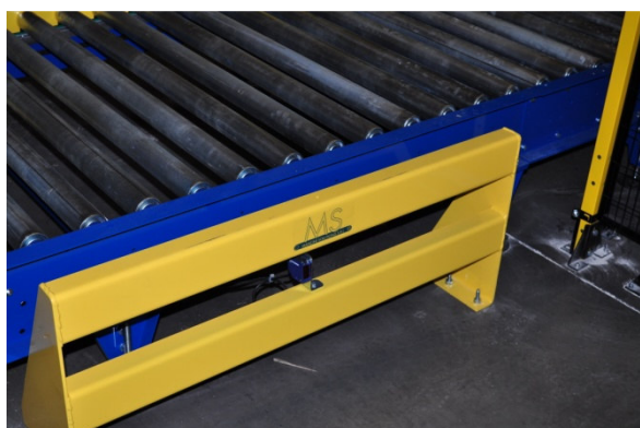
BARRIERA DÌ SICUREZZA CON RILEVAMENTO CARRELLO ELEVATORE
