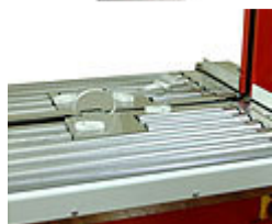
Espulsore anello reggia, funzione anti inceppamento
