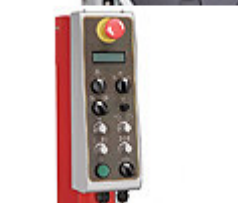
Pannello di controllo con display di segnalazione stato macchina
