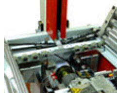
Trasmissione moto ai trasporti con cinghie dentate
