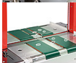
Espulsore anello reggia, dispositivo anti inceppamento reggia
