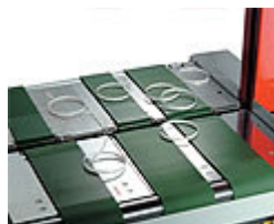
Espulsore anello reggia, funzione anti inceppamento
