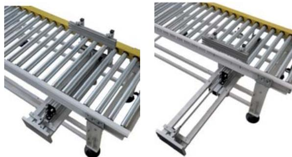
I deviatori Pneumatici vengono realizzati in differenti tipologie, e sono configurati secondo le specifiche esigenze del cliente.
